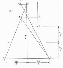
Bild 9. Geometrische Konstruktion des Parabel-Scheitelpunktes aus drei Punkten A, B und C. a) beliebige Abszissenintervalle, b) Abszissenintervall zwischen A und B gleich jenem zwischen B und C.
