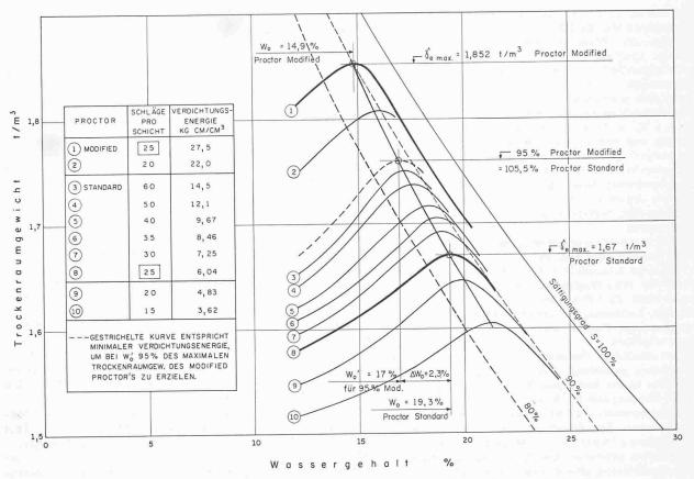
Bild 5. Einfluss der Verdichtungsenergie auf das maximale Trockenraumgewicht und den optimalen Wassergehalt, und Gegenüberstellung der Verdichtungskennwerte des Proctor-Modified und Proctor-Standard. Materialprobe von der Ilha d'Agua (Klassifikation dieses Materials siehe Bild 6)
