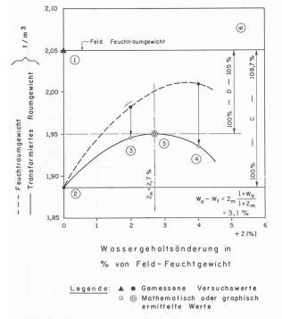
Bild 7. Diagramm eines Kontrollversuches bei spezifiziertem Verdichtungsgrad grösser als 100%. Numerisches Beispiel von Ilha d'Agua. Die Kreisnummern entsprechen den in Kapitel II beschriebenen einzelnen Schritten
