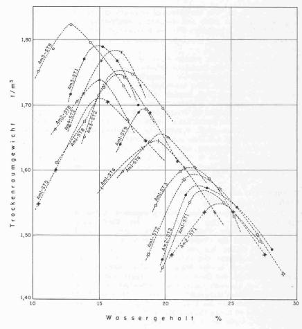
Bild 4. Proctor-Verdichtungskurven von Proben aus der Entnahmezone eines Dammes in Brasilien. Variationen mit Flächenausdehnung und Tiefe. Quelle: Literaturverzeichnis [3]
