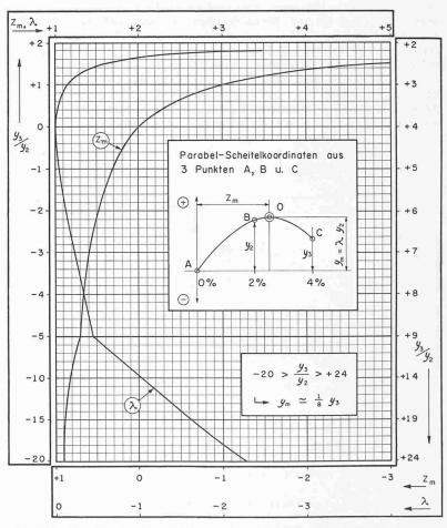
Bild 10. Koordination des Scheitelpunktes einer Parabel mit senkrechter Axe aus drei Punkten A, B und C.  $y_2$  ist gleich der Differenz der Ordinaten von E und A,  $y_3$  gleich jener von C und A. Ist das Abszissenintervall zwischen A und B, bzw. zwischen B und C gleich 1%, so muss das eruierte  $z_m$  mit 0.5 multipliziert werden. Ist es dagegen 3%, so muss  $z_m$  mit 1.5 multipliziert werden.
