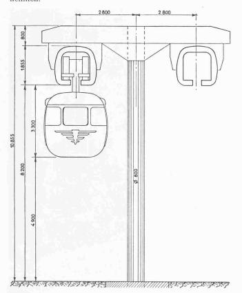
Bild 1. T-förmiger Tragmast der Hochbahn, 1:110
