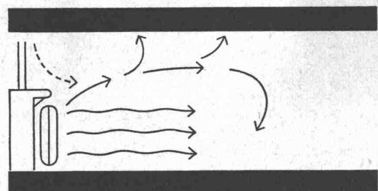
1. Die Fensterkälte, die sinken möchte, wird von der Radiatorenwärme, die steigen möchte, aufgefangen. Der entstehende Wärmestrom verteilt sich gleichmäßig im Raum.
