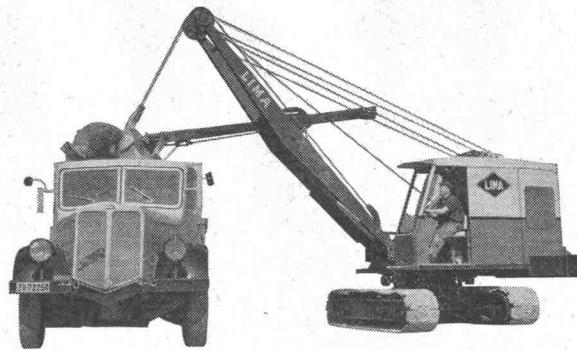
LIMA Raupenbagger sind für härtesten Einsatz konstruiert, schnell, wirtschaftlich, einfach zu bedienen. Modelle von 600 bis 4600 l. Der hier im Einsatz stehende LIMA Typ 25 mit Druckluftsteuerung hat einen Löffelinhalt von 600 l und ist mit einem GM Dieselmotor von 69 PS ausgerüstet. Lieferbar mit Hoch-/Tieflöffel-, Dragline-, Greifer- und Kran-Ausrüstung. Kurzfristig ab Lager. Interessante Konditionen. Verlangen Sie ein unverbindliches Angebot. Charles Keller Wallisellen, Tel. 051/93 39 33
