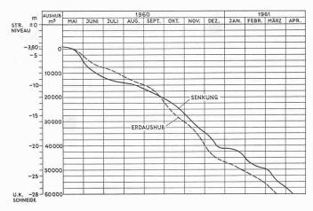
Bild 9. Senkungsdiagramm des Brunnens
