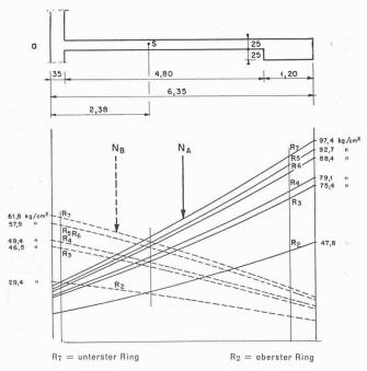
Bild 8. Druckspannungen in den Deckenringen im Zustand 4
