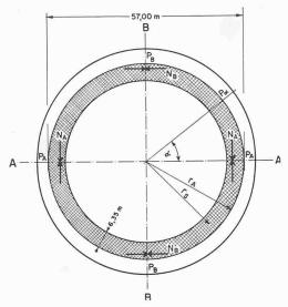
Bild 6. Erddruckverteilung im Horizontalschnitt, Masstab 1:1200
