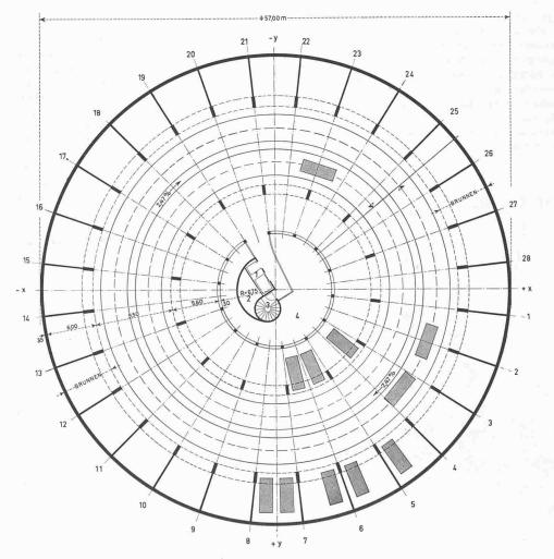
Bild 3. Grundriss Garage, Masstab 1:500. — Zahlen im Zentrum: 1 Aufzüge, 2 Ventilation, 3 Fluchttreppe, 4 Luftraum
