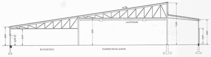
Bild 49. Lagerhalle Goldschmid bei der Station Wülflingen. Arch. M. Krentel, Winterthur. Querschnitt 1:300 durch Lagerhalle und Biegerei. Bild 50 (rechts) Modell
