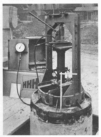
Bild 13. Belastungs- und Messvorrichtung der in ein Bohrrohr des Benotopfahles eingesetzten  $M_E$ -Sonde für Druck- und Zugsbelastung (Firma  $H.\ Hatt-Haller)$
