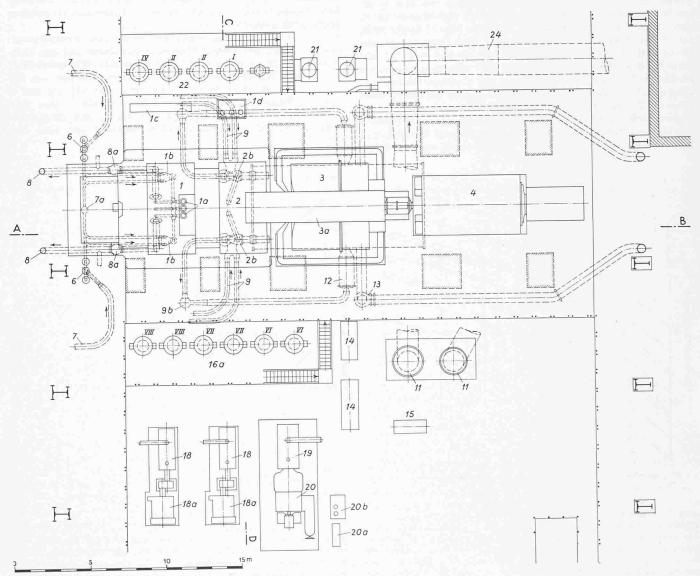
Bild 3a. 115-MW-Dampfturbinengruppe in der Zentrale Baudour  $1\!:\!250$
