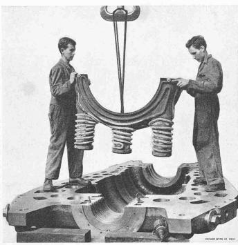
Bild 4. Kühlschirm mit aufgeschweissten Rohren beim Einbau in das Hochdruck-Gehäuse
