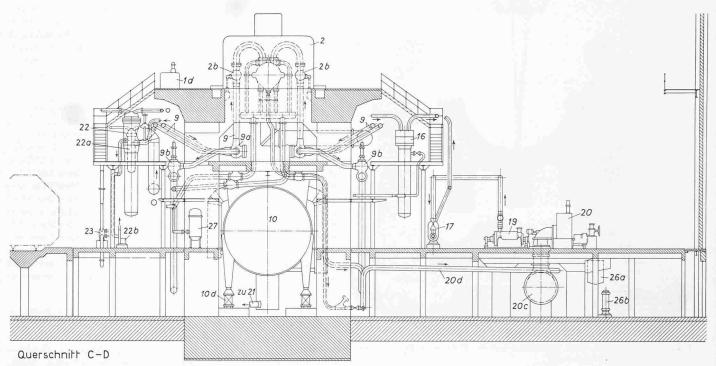
Bild 3b. Querschnitt durch die Dampfturbinengruppe 1:250
