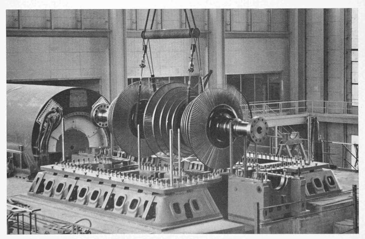
Bild 13. Dreiflutiger Läufer der Niederdruckturbine bei der Montage im Kraftwerk Baudour. Die Korrekturgewichte sind in sieben, über die ganze Länge des Rotors verteilten Nuten angebracht, um die Wuchtfehler möglichst in ihrer eigenen Ebene zu korrigieren
