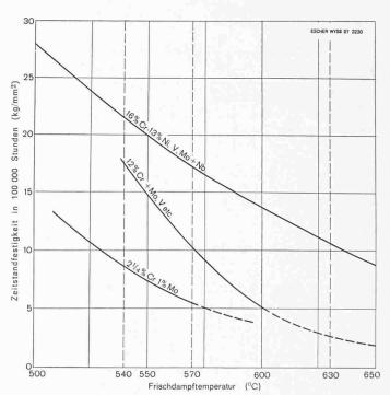
Bild 2. Zeitstandfestigkeit (Bruch nach 100 000 Stunden) für austenitischen (obere Kurve) und ferritischen Stahl (mittlere und untere Kurve. Der Stahl mit 12 % Cr und Zuschlägen (mittlere Kurve) wurde bei der Baudourturbine verschiedentlich verwendet. Ueber seine Eigenschaften s. «Schweizer Archiv» 1961, Nr. 3, S. 121 und SBZ 1961, Heft 19, S. 327
