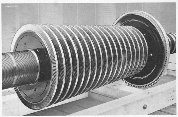
Bild 12. Hochdruck-Rotor mit grossem Regelrad am Eintritt und 18 Gleichdruckstufen. Der Rotor besteht aus einem Stück aus 12 % Chromstahl mit Zusätzen. In den Scheiben sind Nuten zum Einsetzen der Balanciergewichte vorgesehen
