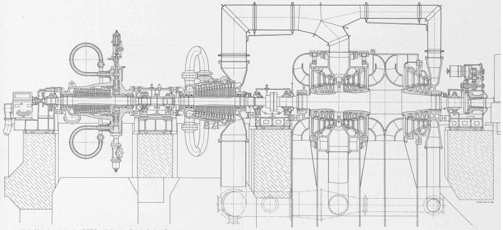
Bild 9. Längsschnitt durch die 115-MW-Dampfturbine der Zentrale Baudour für 165—170 at, 595—600°C und Zwischenüberhitzung auf 565—570°C. Der dreiflutige Niederdruckteil ist in einem einzigen Niederdruckgehäuse angeordnet und vom heissen Mitteldruckgehäuse völlig getrennt. Die Mitteldruckturbine und die Verbindungsleitungen von dieser zur Niederdruckturbine sind völlig symmetrisch ausgebildet
