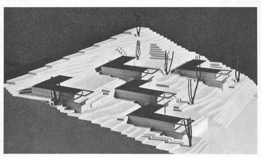
Bild 39. Gesamtansicht des Modells von Norden. Die Staffelung der Bauten ermöglicht trotz konzentriertem Grundriss eine klare Abtrennung der einzelnen Häuser
