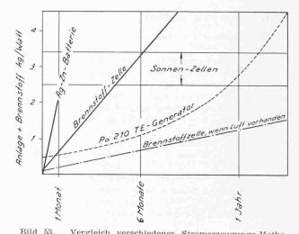
Bild 53. Vergleich verschiedener Stromerzeugungs-Methoden. Bei Anwendungen, wo nur nach langer Zeit oder überhaupt nie (Satellit) aufgetankt werden kann, ist meist folgende Aufgabe zu lösen: die notwendige Leistung soll während der verlangten Zeit mit dem kleinsten Anlage-Gewicht (einschliesslich Brennstoff) erzeugt werden
