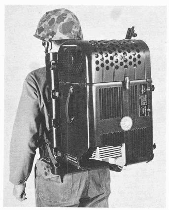
Bild 51. GE-Modell AE 12 Brennstoffzellen «Power Pack». Das Gewicht beträgt 14 kg einschliesslich einem Brennstoffkanister, der oben, unter dem gelochten Blech, angeschlossen wird. Der mehrmals brauchbare Kanister enthält Brennstoff für 14 Volllast-Stunden: 200 W bei 22 bis 28 V. Die untere Ecke ist herausgeschnitten und man sieht einige der dreissig Zellen von 11" × 11", die horizontal übereinander geschachtelt sind
