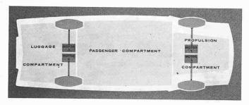
Bild 44. De Soto Projekt «Cella 1». Der Verbrennungsmotor ist durch Brennstoffzellen ersetzt. Jedes Rad wird von einem eigenen hochtourigen Elektromotor angetrieben. Beim Bremsen und Bergabfahren wirken diese als Generatoren, und die Energie wird in Hochleistungsbatterien gespeichert. Neben sehr ruhigem Lauf und günstigem Drehmomentverlauf wären vor allem die sauberen, ungiftigen, geruchlosen Abgase ein grosser Vorteil
