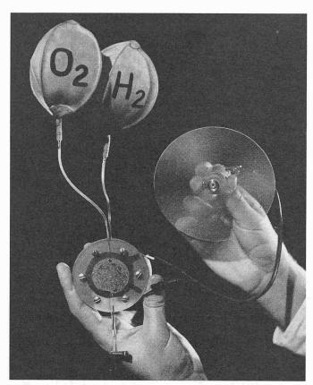
Bild 50. Demonstrationsmodell einer GE-Membran-Brennstoffzelle nach Bild 49. Man erkennt die Wassertropfen, die sich an der O2-Elektrode abscheiden. Die Elektrolyt-Membran ist nur 0,6 mm dick und weist eine Fläche von 11,4 cm² auf. Bei thermischem Wirkungsgrad (bezogen auf den oberen Heizwert) von 62 % werden 0,9 V . 0,03 A = 0,027 W abgegeben. Die Zelle trieb den kleinen Elektromotor während 100 Tagen
