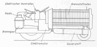
Bild 46. Schematische Darstellung des elektrochemisch angetriebenen Allis-Chalmers Traktors. Der Radio wurde eingebaut, um den ruhigen Lauf des Antriebs zu demonstrieren. Selbst beim Pflügen unter Vollast konnte man den Sendungen mühelos zuhören
