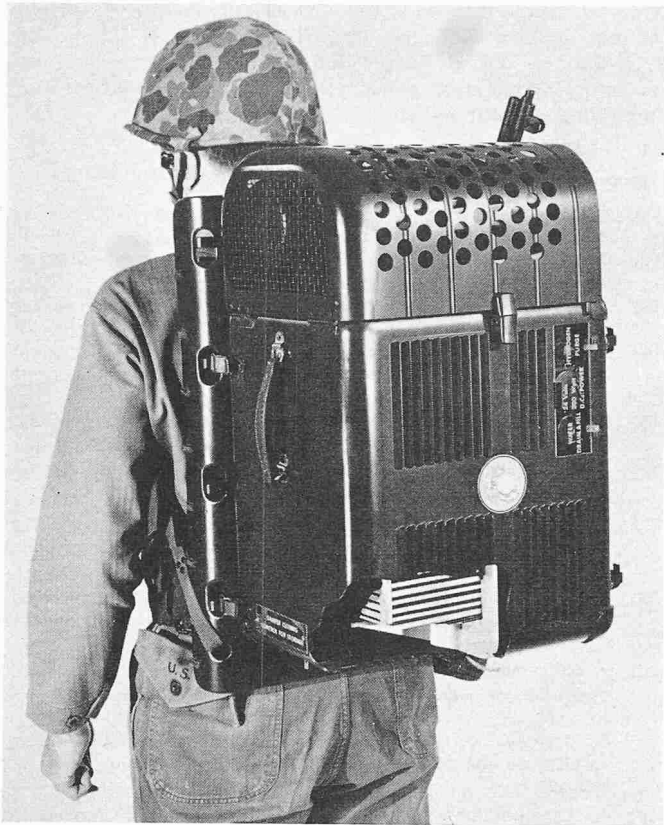
Bild 51. GE-Modell AE 12 Brennstoffzellen «Power Pack». Das Gewicht beträgt 14 kg einschliesslich einem Brennstoffkanister, der oben, unter dem gelochten Blech, angeschlossen wird. Der mehrmals brauchbare Kanister enthält Brennstoff für 14 Vollast-Stunden: 200 W bei 22 bis 28 V. Die untere Ecke ist herausgeschnitten und man sieht einige der dreissig Zellen von 11" x 11", die horizontal übereinander geschichtet sind
