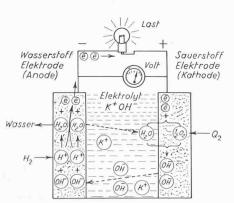
Bild 43 (links). Der elektrochemische Prozess in der H2-O<sub>2</sub>-Brennstoffzelle. Der von links in die Anode tretende Wasserstoff wird unter Elektronenabgabe in gespalten. Die Elektronen fliessen ab, in der Last Arbeit und gelangen zur Kathode, an der sie mit dem eintretenden O2 und dem Elektrolyten zu OH- reagieren. Die
