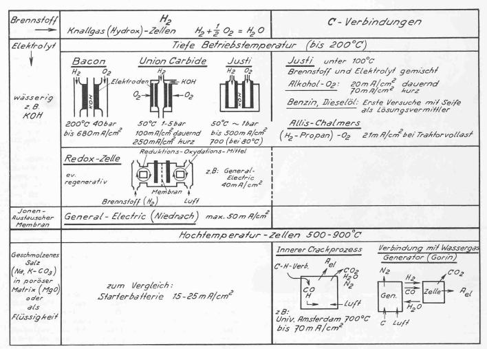
Bild 48. Uebersicht über die Brennstoff-Zellen
