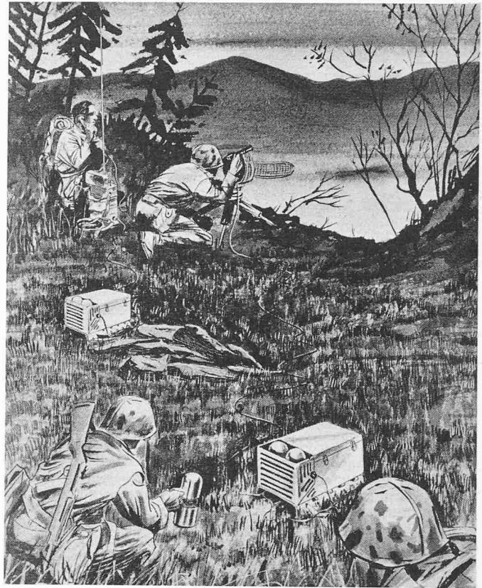
Bild 52. Die GE-Brennstoffzellen-Generatoren eignen sich zum Einsatz in Frontnähe, da sie lautlos sind, keinen Rauch und wenig Wärme entwickeln. Im Bild liefern sie Strom für ein Uebermittlungs- und Beobachtungsgerät. Eine Einheit von 14 kg (gemäss Bild 51) leistet das selbe wie ein Benzinmotor-Generator von 23 kg oder gewöhnliche Batterien von insgesamt 36 kg. Pro weitere 14 Stunden benötigt man nur je einen weiteren Brennstoffkanister von 2,7 kg. Für eine Woche reichen also 32 kg Brennstoff aus, verglichen mit fast einer halben Tonne gewöhnlicher Batterien. Leichte Stromquellen geben der Truppe erhöhte Beweglichkeit
