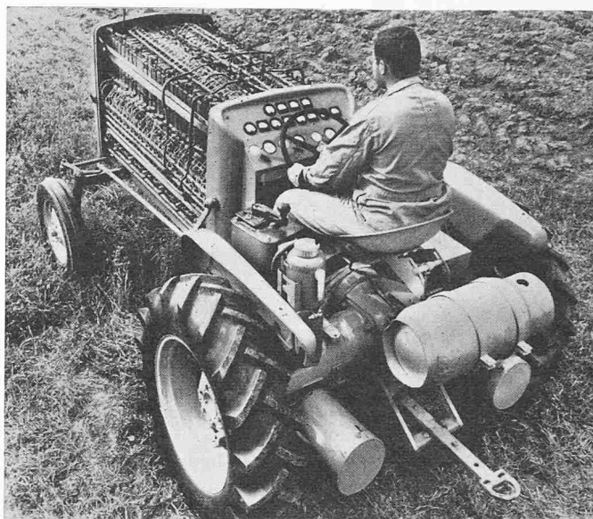
Bild 45. Allis-Chalmers Versuchstraktor. Er ist mit 1008 Brennstoffzellen ausgerüstet, die dort eingebaut sind, wo sich üblicherweise der Verbrennungsmotor befindet. Man beachte die Gaszufuhr-Leitungen und die elektrischen Anschlüsse. Es sind immer so viele Zellen in Serie geschaltet, dass sich ungefähr 60 V Gleichspannung ergibt. Der Motor von 20 PS treibt die Hinterachse an. Mit dem Kontrolller kann die Geschwindigkeit reguliert und auf elektrische Bremsung geschaltet werden. Man bemerkt hinter dem Führersitz die Druckflasche für das Brenngas (das Propan enthält), links unten das Ende einer Sauerstoff-Flasche
