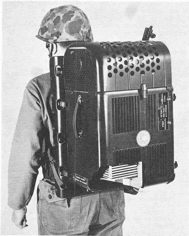
Bild 51. GE-Modell AE 12 Brennstoffzellen «Power Pack». Das Gewicht beträgt 14 kg einschliesslich einem Brennstoffkanister, der oben, unter dem gelochten Blech, angeschlossen wird. Der mehrmals brauchbare Kanister enthält Brennstoff für 14 Volllast-Stunden: 200 W bei 22 bis 28 V. Die untere Ecke ist herausgeschnitten und man sieht einige der dreissig Zellen von 11" x 11", die horizontal übereinander geschachtelt sind
