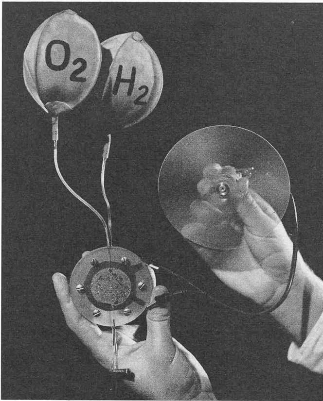
Bild 50. Demonstrationsmodell einer GE-Membran-Brennstoffzelle nach Bild 49. Man erkennt die Wassertropfen, die sich an der O_2 -Elektrode abscheiden. Die Elektrolyt-Membran ist nur 0,6 mm dick und weist eine Fläche von 11,4 cm 2 auf. Bei thermischem Wirkungsgrad (bezogen auf den oberen Heizwert) von 62% werden 0,9 \text{ V} \cdot 0,03 \text{ A} = 0,027 \text{ W} abgegeben. Die Zelle trieb den kleinen Elektromotor während 100 Tagen
