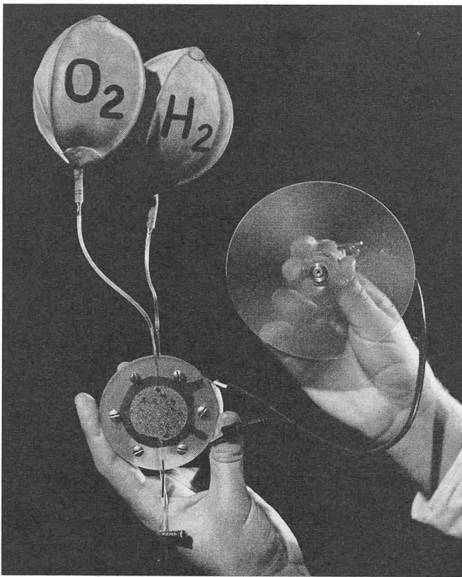
Bild 50. Demonstrationsmodell einer GE-Membran-Brennstoffzelle nach Bild 49. Man erkennt die Wassertropfen, die sich an der O 2 -Elektrode abscheiden. Die Elektrolyt-Membran ist nur 0,6 mm dick und weist eine Fläche von 11,4 cm 2 auf. Bei thermischem Wirkungsgrad (bezogen auf den oberen Heizwert) von 62% werden 0,9 V · 0,03 A = 0,027 W abgegeben. Die Zelle trieb den kleinen Elektromotor während 100 Tagen
