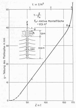
Bild 1. Last-Hebungsdiagramm eines auf Zug beanspruchten Bohrpfahles  $\phi$  60 cm, System Icos-Veder (Veba). Untergrundverhältnisse: 0 bis 3 m Auffüllungen, 3 bis 12 m Kiessand, 12 bis 18 m schwarzer Schlammsand mit organischen Resten (weich), ab 18 m grauer Schlammsand, festgelagert, magerer Lehm (Uebergang in feinkörnige Moräne) vermutlich vorbelastet durch den Limmatgletscher (Grundwasser rd. 3,50 m unter Bodenoberfläche)
