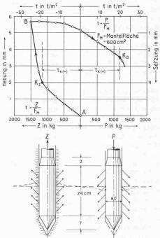
Bild 2. Last-Hebungs- und Last-Setzungsdiagramme eines auf Zug bzw. Druck beanspruchten Modell-pfahles gemäss Bild 11 und 12. Bodenart: Grauer Schlammsand bis magerer Lehm, festlagert. Tiefe der Versuchsstelle unter Bohrplanum rd. 24,3 m, unter Bodenoberfläche rd. 27,3 m. Grundwasserspiegel rd. 3,2 m unter Bodenoberfläche
