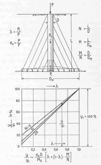
Bild 3. Wirkungsweise der vom Mantel und von der Spitze auf den Untergrund übertragenen Lasten. Abhängigkeit der Setzung y der Pfahlbasis vom Anteil  $\lambda$  der Spitzenlast  $P_1$  an der Gesamtlast P (vereinfachte Darstellung). Genauere Berechnung siehe Bild 10
