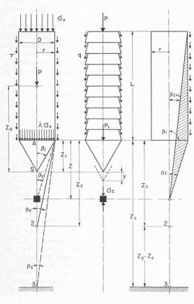
Bild 7 (links). Wirkungsweise eines zylindrischen Pfahles mit gleichmässig über die Mantelfläche verteilten Schubspannungen, bzw. eines Modellpfahles mit Reibungszylinder. Annahmen für die Setzungsberechnung
