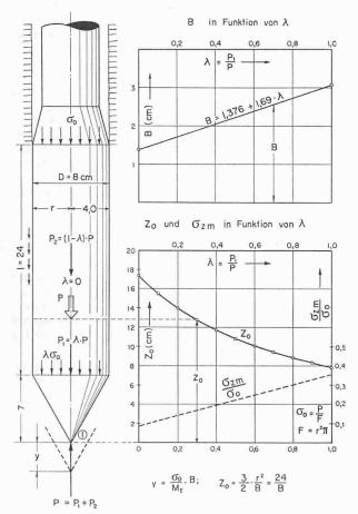
Bild 9. Diagramm (oben) zur Bestimmung des für die Setzungsberechnung massgebenden aequivalenten Durchmessers B des Modellpfahles in Funktion von  $\lambda$ , bzw. des Anteils der Spitzenlast  $P_1$  an der Gesamtlast P. (Die Höhe  $t_0$  des unteren Diagrammes erlaubt, den Angriffspunkt einer fiktiven Einzellast P zu ermitteln, welche theoretisch die selbe Setzung der Pfahlspitze I erzeugt wie der Modellpfahl)
