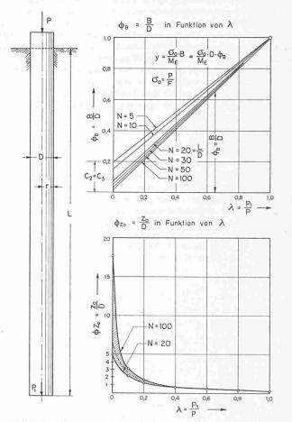
Bild 10. Diagramm oben dient zur Bestimmung des für die Setzungsberechnung massgebenden aequivalenten Durchmessers B eines zylindrischen Pfahles in Funktion von  $\lambda$  für verschiedene Schlankheitsgrade N=L:D. (Darin bedeutet L die aktive Pfahllänge d. h. die Länge der Mantelfläche, über welche sich die Schubspannung gleichmässig verteilt)
