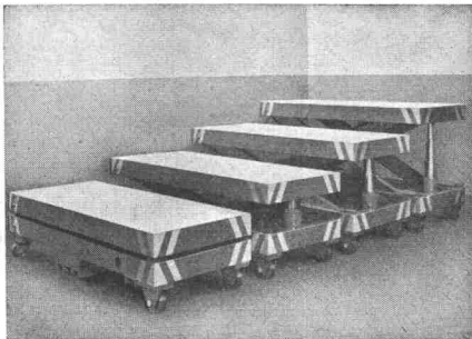
Fahrbahre hydr. Hebetische zur Vereinfachung des Trans- portes von Blechen von Ma- schine zu Maschine. Hubkraft 10 000 kg Tischgrösse 1 x 2,5 m
