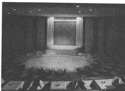
Hydr. Attraktions- und Orche- sterbühnen in einem Kursaal. Grösse der Bühnen: oval 10 x 13 m, Ø 9,6 m Hubhöhen ca. 4,9 m Hubkraft 10 000 kg
