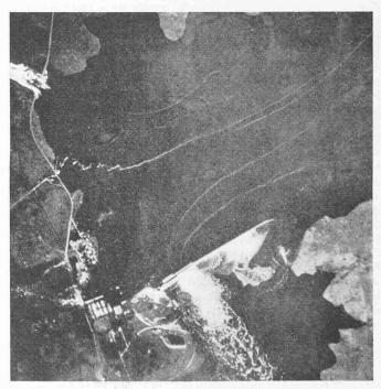
Bild 12 a. Luftaufnahme des Kraftwerks Rincon del Bonete mit Umgebung zur Zeit des grössten Hochwassers. Der Damm wird auf seiner vollen Länge überströmt; am rechten und linken Dammende findet ein Umlauf statt. Am rechten Seeufer ist die gesprengte Entlastungsöffnung ersichtlich. Interessant sind die Strömungslinien im Stausee
