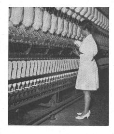
Teilansicht einer Rieter Baumwoll-Ringspinnmaschine, welche die Rentabilität und damit die Wettbewerbsfähigkeit einer Spinnerei wesentlich zu verbessern vermag. Die Erstleistungen und Erfindungen Rieters im Bau von Ringspinnmaschinen dienten seit Jahrzehnten als Vorbilder für die Spinnereitechnik. Sie haben in entscheidender Weise dazu beigetragen, die führende Stellung Rieters zu begründen und zu festigen.
