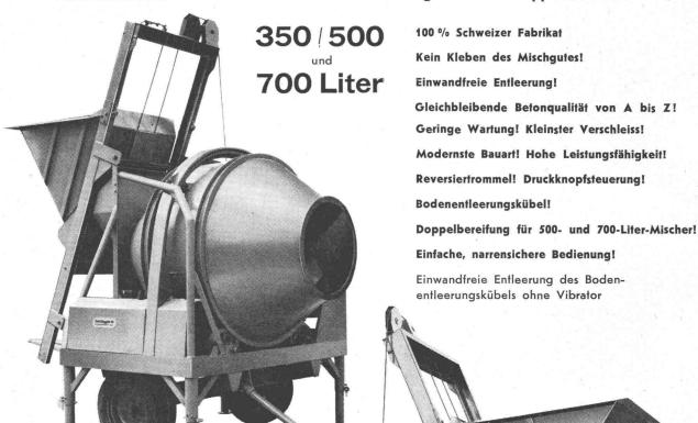
Antrieb über **zwei** getrennte, im Oelbad laufende Elektro-Getriebemotoren.
