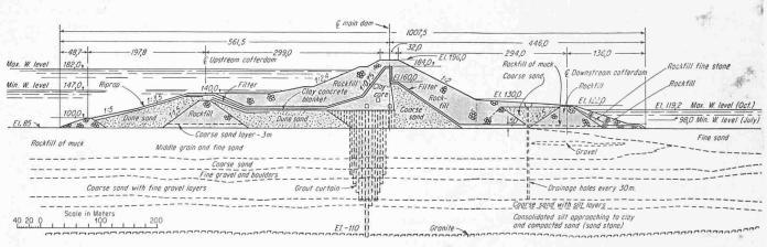
Querschnitt 1:7200 des nun im Bau begriffenen Hochdammes bei Assuan
