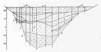
Ueberhöhter Querschnitt durch das Talprofil des Nils an der Dammbaustelle. 1 Feinsand, 2 Mittelsand, 3 Grobsand, 4 Steine, 5 Kies, 6 Grobsand mit Schlammschichten, 7 stark zusammengedrückter Schlamm mit Sandsteinschichten, 8 Granit, 9 Tiefbohrungen
