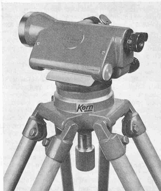
Bild 1 (rechts). Kern-Ingenieur-Nivellier GK 23 auf Gelenkkopfstativ
