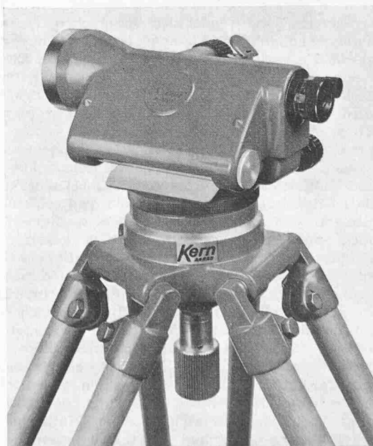
Bild 1 (rechts). Kern-Ingenieur-Nivellier GK 23 auf Gelenkkopfstativ
