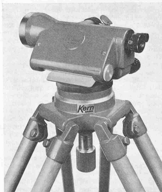
Bild 1 (rechts). Kern-Ingenieur-Nivellier GK 23 auf Gelenkkopfstativ
