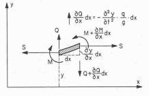
man ein Seilelement (Bild 2) heraus, das durch die d'Alembertsche Trägheitskraft belastet ist.
