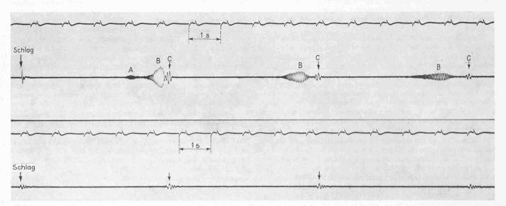
Bild 8. Schlagwellenmessung an vollverschlossenem Tragseil von 39 mm Dicke, mittlere Zugkraft 39,5 t, Messtelle in 2,8 m Abstand vom Feldende. Oben (a) Schlag mit Bleihammer in 2 m Abstand vom Feldende; unten b) Ruckartiger Zug mit vier Armen in 4 m Abstand vom Feldende mittels Hanfseil
