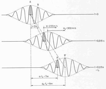
Bild 4. Wellenpaket am biegungssteifen Seil. Jede Einzelwelle bewegt sich mit der Phasengeschwindigkeit a, das Gruppenzentrum mit der grösseren Gruppengeschwindigkeit  $a_G$
