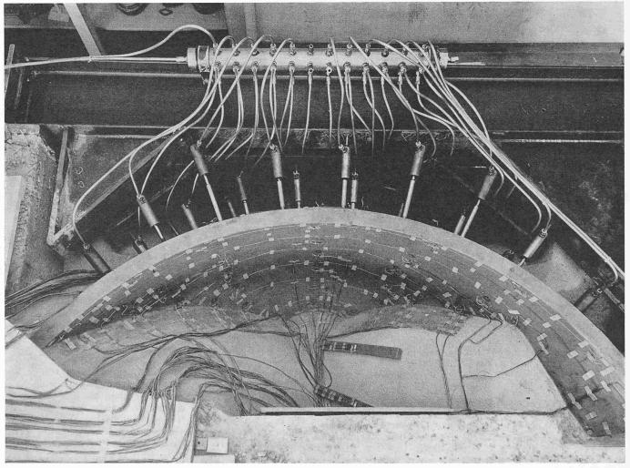
Bild 3. Fertig verdrahtetes Modell der Staumauer Sufers
