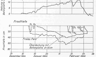
Bild 13. Beobachtungen über die Frosteindringung auf freiem Feld und unter einer 15 cm starken Betonplatte. Man beachte das rasche Auftauen der gefrorenen Zone, sobald die Lufttemperatur steigt.
