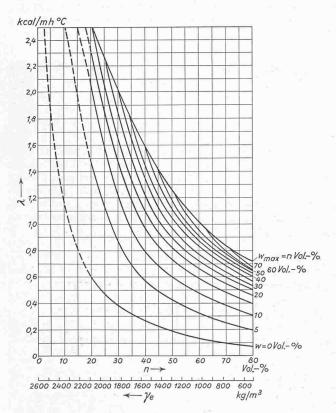
Bild 12. Abhängigkeit der Wärmeleitzahl der verschiedenen Bodenarten von Raumgewicht, Porenvolumen und Wassergehalt nach Kersten, Krischer und neueren russischen Angaben
