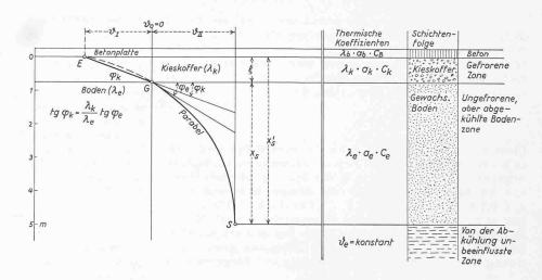
fläche des Wassers eine Eisschicht, deren Dicke mit der Zeit zunimmt. Stephan hat unter Berücksichtigung der Gefrierwärme  $\sigma$  die nachstehende Formel zur Berechnung der Eisdicke abgeleitet [2] S. 144
