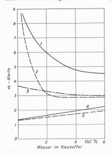
Bild 19a (links). Vergleich der Formeln von Stephan 1, Berggren 2, Emblick 3, Neumann 4 und Ruckli 5 unter Berücksichtigung der Gefrierwärme des im Koffer enthaltenen Wassers. Aufgetragen sind die α-Werte in Formel (A) in Abhängigkeit des Wassergehaltes in Vol. %.
