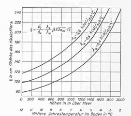
Bild 18. Zunahme der Kieskofferstärke mit abnehmender mittlerer Jahrestemperatur bzw. mit zunehmender Meereshöhe für verschiedene Wärmeleitzahlen des Koffermaterials bei einer Temperatur im Kühlröhrensystem von — 8°C und einer Temperaturleitzahl von 0,0020 m²/h, einer Wärmeleitzahl des Bodens von 1,2 kcal/mh °C und einer Betriebsdauer von
