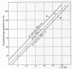
Bild 17. Beziehung zwischen Frosteindringungstiefe  $\xi$  (Tiefe der Nullisotherme) und dem Frostindex nach den Angaben des US Corps of Engineers. Bei der Berechnung des Frostindex F sind die Temperaturen in Fahrenheit und die Zeit in Tagen einzusetzen [26], Bull. 225. Die Kurve A gilt für Gradtage bei Bezugstemperaturen von 29 ° F, Kurve B für solche von 32 ° F und Kurve C für solche von 30 ° F
