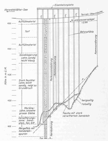
Bild 8c. Geologisch-hydrologischer Querschnitt durch die Fundation der Kunsteisbahn Luzern. V= Visurlinie; während des Pfählens bewegte sich das Gelände um rd. 5 cm seewärts. F= Felsoberfläche, wie sie auf Grund geophysikalischer Verfahren, Schlagbohrungen, Kernbohrungen und Rammsondierungen vorausbestimmt wurde.
