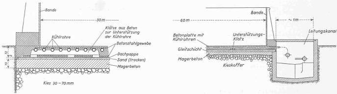
Bilder 4a und 4b. Einzelheiten der Plattenausführung bei der Kunsteisbahn Landsberg, erstellt 1957, 1:20 bzw. 1:50. Eigentümer: Eisbahnverein Landsberg, Ersteller: Escher Wyss GmbH, Lindau, Berater: Dr. L. Bendel
