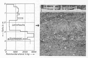
Bild 2a. Beispiel einer Rammsondierung (Kunsteisbahn Sonthofen), Durchmesser der Sonde 45 mm
