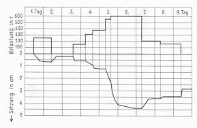
Bild 7. Zeitsetzungsdiagramm des Rammpfahles Ø 0,915 Meter
