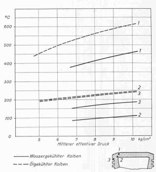
Bild 19. Verlauf der an drei charakteristischen Stellen des Kolbenbodens gemessenen Temperaturen in Abhängigkeit des mittleren effektiven Kolbendruckes bei Wasserkühlung (ausgezogene Linien) und bei Oelkühlung (gestrichelte Linien). Die Messungen wurden am Einzylinder-Versuchsmotor 1 RSA 76 durchgeführt
