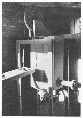
Fig. 5. Vase à fuite permanente (7), poulie (8) et déversoir oscillant (9)
