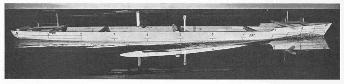
Bild 5. Das Schiffsmodell 1:11 im Schleppkanal der Hamburgischen Schiffbau-Versuchsanstalt bei einer Geschwindigkeit von 29,08 km/h
