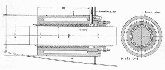
Bild 12 (links). Lager zur Propellerwelle mit Gummiauskleidung, 1:8
