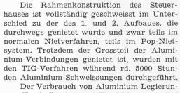
Der Verbrauch von Aluminium-Legierungen für Aufbauten und Einrichtungen belief sich auf 35 t in Blechen und Profilen, wobei zur Hauptsache Anticorodal 13 (Al Si Mg), Unidal (Al Zn Mg) und Extrudal (Al Si Mg) verwendet wurde. Die konsequente Verwendung von Leichtmetall für die Aufbauten gründet sich auf eine 30jährige Erfahrung der SGV. Die hauptsächlichsten Vorteile dieser Bauart sind:
