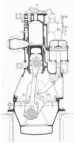
Bild 8 (links). Querschnitt durch den Sulzer-Zweitakt-Schiffsdieselmotor 6 TW 24 mit angebauten Spülluftpumpen
