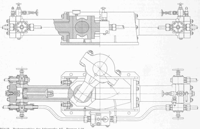
Bild 19. Rudermaschine der Atlaswerke AG., Bremen 1:10
