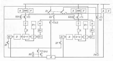
Bild 14. Schema der elektrischen Zentrale
