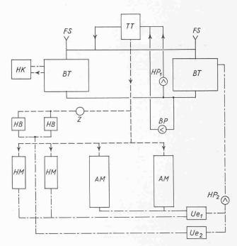
Bild 18. Blockschema des Brennstoffsystems
