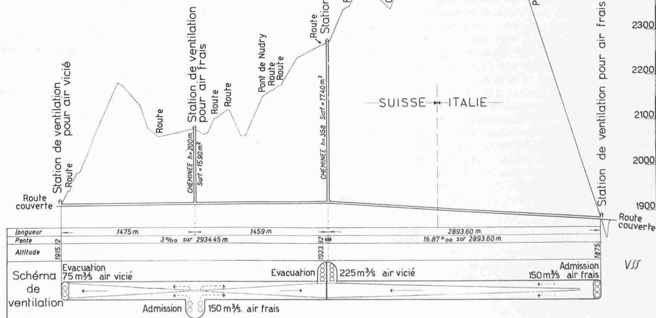
sammenarbeit mit der Oberbauleitung des Tunnels, Ing. H. Felber, Monthei, projektiert wurde und von dieser Firma auch ausgeführt wird, ist für einen Spitzenverkehr von rd. 500 Personenfahrzeugen pro Stunde bemessen, der an Wochenenden und während der Ferienzeit zu erwarten ist. Die durchschnittliche Verkehrsdichte wird erheblich kleiner sein.
