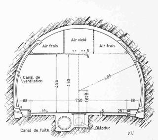
Bild 2. Normalquerschnitt durch den Tunnel auf der schweizerischen Seite; unter der Fahrbahnplatte die Oelleitung und der Unterwasserkanal, über der Decke der Abluftkanal und beidseitig die beiden Frischluftkanäle
