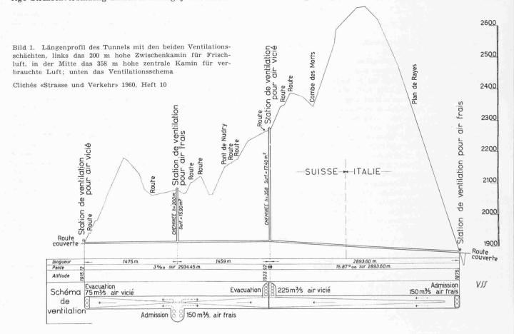
sammenarbeit mit der Oberbauleitung des Tunnels, Ing. H. Felber, Monthey, projektiert wurde und von dieser Firma auch ausgeführt wird, ist für einen Spitzenverkehr von rd. 500 Personenfahrzeugen pro Stunde bemessen, der an Wochenenden und während der Ferienzeit zu erwarten ist. Die durchschnittliche Verkehrsdichte wird erheblich kleiner sein.
