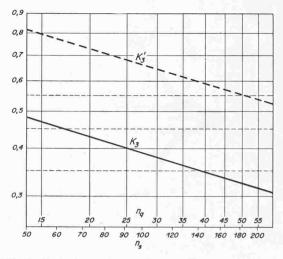
Bild 6. Verlauf der Werte  $K_3$  und  $K_{3'}$  in Abhängigkeit von  $n_s$  bzw.  $n_q$ . Dabei ist  $K_{3'}=K_3$   $2\,\eta_h$  mit  $\eta_h=0.85$
