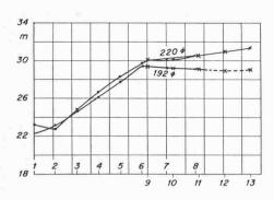
Bild 19 (links). Messpunkte 1 bis 13 für Leitrad 220 und 192 mm Durchmesser bei V=9 l/s über der Abwicklung A-B aufgetragen
