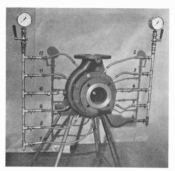
Bild 2. Spiralgehäuse mit über den Umfang der Spirale verteilten Messtellen
