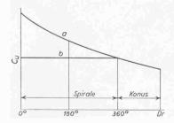
Bild 7. Verlauf der Geschwindigkeiten in einem Spiralgehäuse
