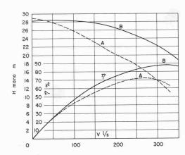
Bild 12. Vergleichskurve für H und  $\eta$ der Pumpe nach Bild 10. A = mit Diffusorgehäuse u. Laufrad a. B = mit Spiralgehäuse u. Laufrad b mit verengtem Eintritt
