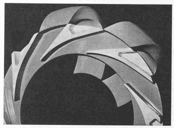
Bild 22. Leitrad mit anschliessendem Ueberströmkanal nach Bild 21a
