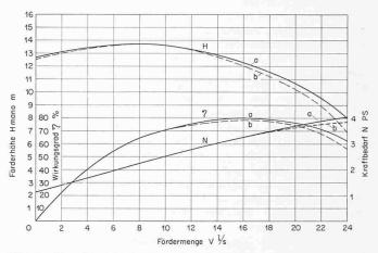
Bild 3. Charakteristische Hauptgrössen einer Kreiselpumpe Kurve a mit Spiralgehäuse nach Drallsatz berechnet Kurve b mit gleichbleibender Geschwindigkeit in der Gehäusespirale
