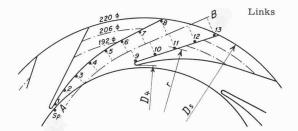
Bild 16. Leitrad einer zweistufigen Pumpe. Um den Einfluss der Leitkanallänge zu bestimmen, wurde der Aussendurchmesser  $\mathrm{D}_5$  von 220 auf 206 und 192 mm geändert.
