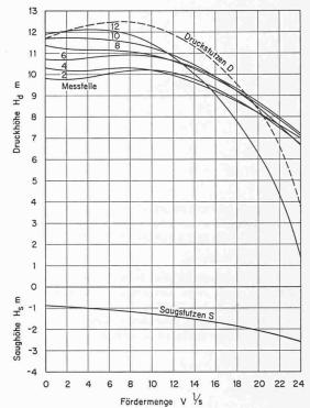
Bild 4b (rechts). Wie Bild 4a, jedoch bei einer für gleichbleibende Geschwindigkeit berechneten Gehäusespirale
