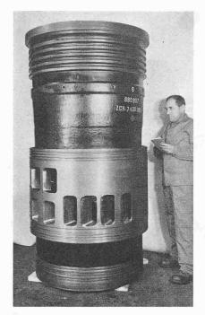
Bild 13. Zylindereinsatz mit Spül- und Auspuffschlitzen
