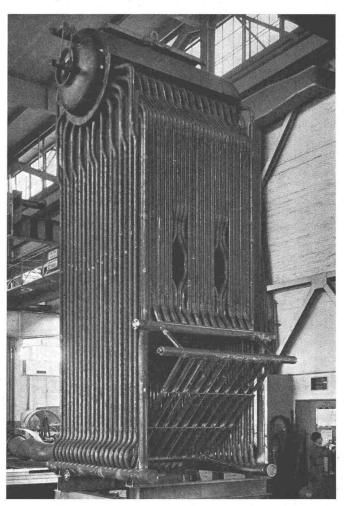
Bild 1. Kesselrohrsystem eines Sulzer-Strahlungskessels zur Erzeugung einer Wärmemenge von 2,5 Mio kcal/h. Die Leistungsgrenze dieser Kesselreihe liegt bei einer Sattdampfmenge von 18 t/h und einer Wärmemenge von 10 Mio kcal/h bei Dampfdrücken von 7 bis 25 atü.
