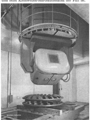
Brown Boveri-Betatron für Materialprüfung von komplizierten Stahlgusstücken.
