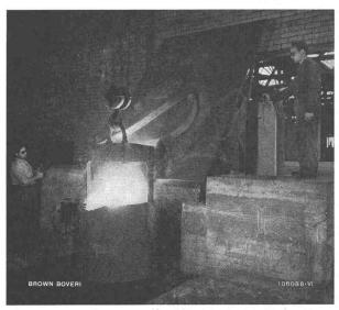
Netzfrequenz-Induktionsschmelzofen für das Schmelzen und Ueberhitzen von Grauguss. Fassungsvermögen 6 t, Anschlusswert 720 kVA,  $500~\rm{V},~50~\rm{Hz}.$
