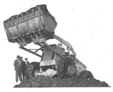
Der Weltmeister der Traktorbagger! Über 250 Michigans arbeiten allein in der Schweiz! Grössen von 425 bis 4600 lt Schaufelinhalt, Motoren bis 375 PS. Vollhydraulisches Schalten, Steuern und Bremsen, daher einfachste Bedienung. Dauernd optimale Kraftübertragung durch hydraulischen Drehmomentwandler. Geringe Beanspruchung des Antriebmechanismus dank Planetengetriebe in jedem Rad. Hohe Fahrgeschwindigkeit, kleiner Wendekreis. Charles Keller Wallisellen, Tel. 051/93 39 33
