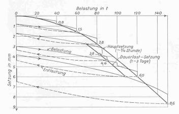
Bild 5. Last-Setzungs-Diagramm des Probepfahls
