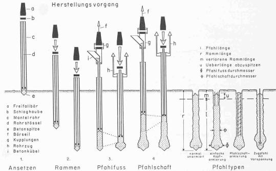
Bild 2. Herstellung von Alpha-Pfählen, Schema und charakteristische Werte
