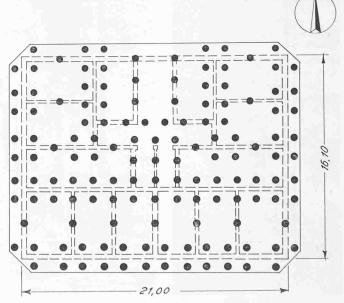
Bild 6. Anordnung der Pfähle im Grundriss des Hochhauses Masstab 1:300
