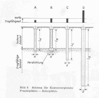
beim Einrammen des Frankirohres. Lediglich in Zweifelsfällen müssen Probebelastungen vorgeschlagen werden. Die Stern'sche Rammformel ziehen wir vor allem dann zu Rate, wenn es gilt, sich Rechenschaft zu geben über die Einflüsse verschiedener Bär- und Rohrgewichte sowie über die Energieverluste infolge der Deformationsarbeit.
