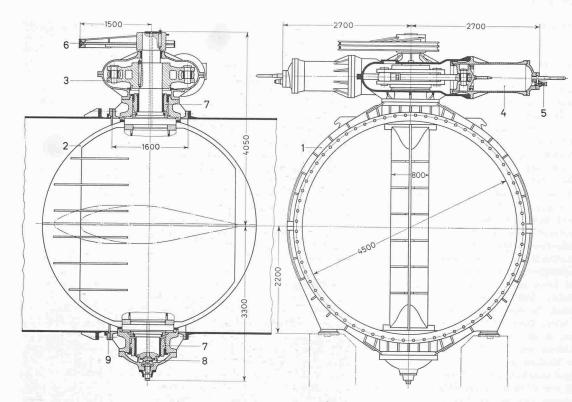
Bild 21. Längs- und Querschnitt durch die Drosselklappe nach Zeichnung von Escher Wyss GmbH., Ravensburg, 1:80
