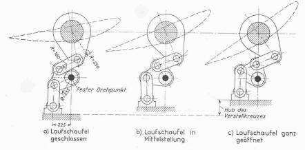
Bild 15. Verstellmechanik der Laufradschaufeln
