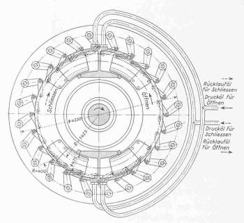
Bild 17. Schema der Ringkolben-Servomotoren mit den Leitschaufelhebeln
