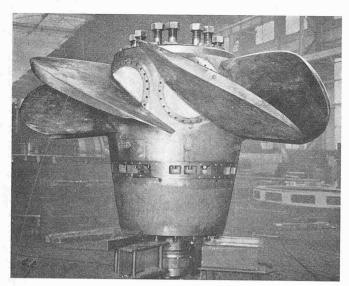
Bild 14. Das Turbinenlaufrad, Werkaufnahme bei J. M. Voith
