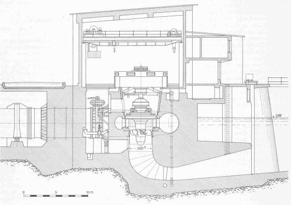
Bild 12. Schnitt durch das Maschinenhaus 1:300
