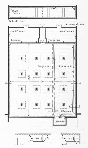
Bild 6. Der Tiefkühlraum 1:400 mit Einzelheiten der Luftkanäle 1:80
