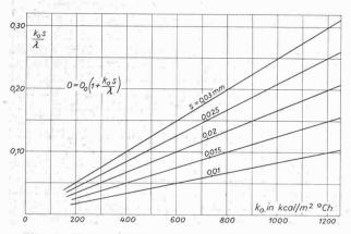
Bild 1. Wegen Oelfilm nötige Vergrösserung der wirksamen Oberfläche von Wärmeaustauschern
