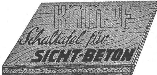
3-schichtig, querverleimt, 28 mm stark. Fabrikationsgrösse 100 × 500 cm oder auf kleinere Masse zugeschnitten. Ueber 50mal verwendbar.
