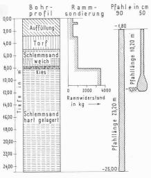
Bild 11. Vergleich der notwendigen Pfahllängen Bohrpfahl/Rammpfahl im Schlemmsand
