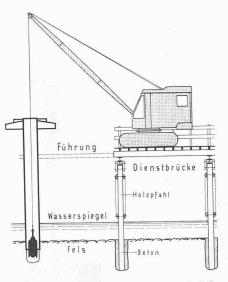
Bild 7. Freivorbau einer Dienstbrücke mit HW-Pfählen im Fels
