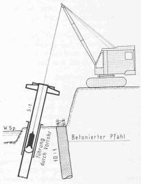
Bild 8. HW-Schrägpfähle an einem Steilufer
