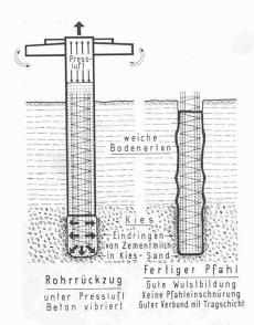
Bild 5. Betonieren unter Druckluft
