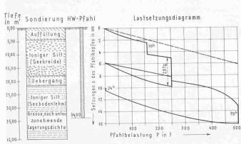
Bild 6. Probebelastung bis 500 t eines HW-Pfahls von 90 cm Durchmesser und 34 m Länge
