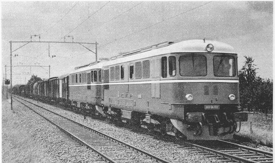
Bild 31. Probefahrt in der Schweiz mit den CFR-Lokomotiven 060-DA-001 und 002 in Doppeltraktion und Vielfachsteuerung mit einem Güterzug (Anhängengewicht 1227 t) auf der SBB-Strecke Winterthur—Romanshorn im Juli 1959.
