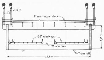
Bild 1. Querschnitt 1:450 durch Hängekabel, bestehende Fahrbahn (oben) und neue Fahrbahn (unten)
