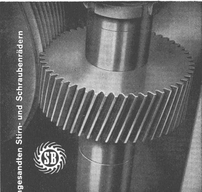
Zähneschleifen an eingesandten Stirn- und Schraubenrädern
