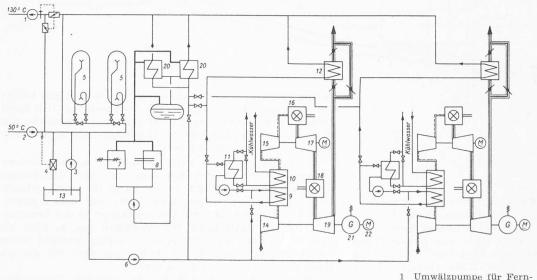
Bild 1. Wärmeschaltbild des Gasturbinen-Kraftwerks Bremen-Vahr
