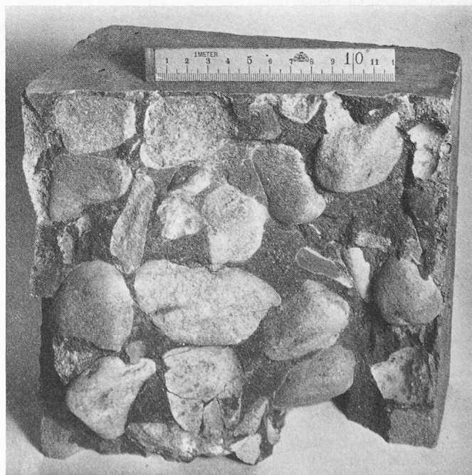
Bild 1. Colcrete-Ausgussbetonprobewürfel von 20 cm Kantenlänge nach der Prüfung auf Druck. Der Mörtel war zum Teil fester als die Grosszuschläge. Die mittlere Druckfestigkeit betrug über 500 kp/cm 2
