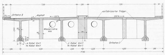
Bild 6. Einhängeträger von 45,95 m in der 85-m-Oeffnung, Querschnitt 1:120. Rechtsfallende Schraffur bedeutet, abgesehen vom Plattenbereich, Ansichtsfläche Ortbeton
