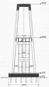
Bild 9. Querschnitt zu Bild 8 in Pfeileraxe, 1:1400
