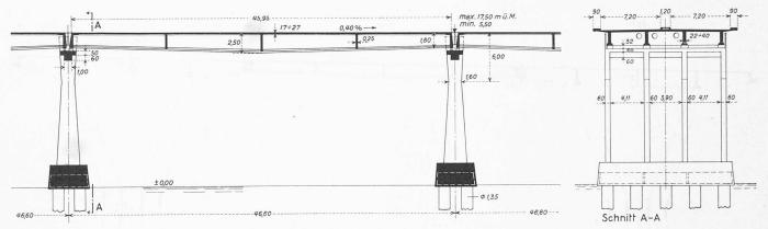
Bild 2. Oeffnungen von 46,60 m, Längs- und Querschnitt 1:500
