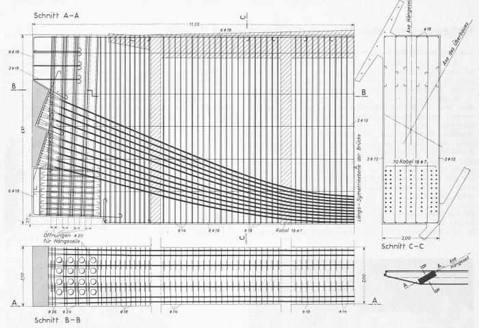
Bild 11. Seilanschluss-Querträger bei b und g in Bild 8. Masstab 1:90
