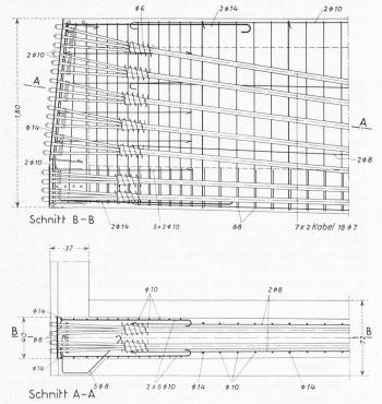
Bild 7. Einhängeträger von 45,95 m, Verankerungszone der Aussenträger, Masstab $1\!:\!40$
