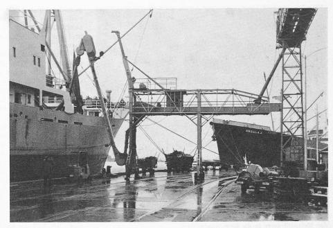
Bild 7. Die eigentlichen Belademaschinen sind auf pneuräderbereifte Stahlgerüste aufgebaut. Diese können nach Beendigung der Operation beiseitegestellt werden, um Platz für andere Umschlagsgüter zu schaffen (Anlage in Haifa wie Bild 6)
