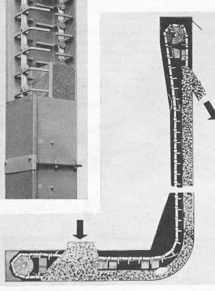
Bild 4. Schema der Vertikalförderung
