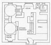
Bild 24 (rechts). Grundriss einer Hauszeile in Gourna Masstab rd. 1:900
