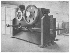
Tafelschere im Stockwerk auf Federdämpfer vibrationsfrei montiert
