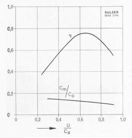
Bild 21. Charakteristik der Expansionsturbinen für Wasserstoff
