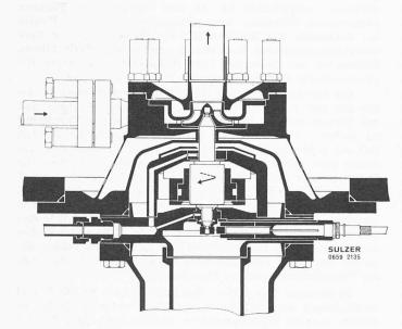
Bild 18. Schnitt durch die Expansionsturbine für Wasserstoff
