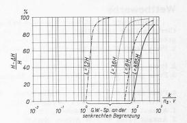
Beim Absenkvorgang ist der Einfluss der Grundwasserträgerlänge L auf die Lage der Hangquelle bei kurzem Grundwasserträger gut spürbar, wird aber verschwindend klein für  $L>5\,H$  (siehe Bild 7). Der Unterschied ist umso kleiner, je näher die Kurven in Bild 7 beieinander liegen. Hingegen ist der Grundwasserspiegel an der senkrechten Begrenzung des Grundwasserträgers sehr stark von dessen Länge abhängig. Erst bei  $L>15\,H$  dürfte der Einfluss verschwindend klein werden.
