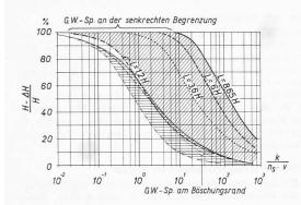
Bild 7 (links). Absenkvorgang: Lage des Grundwasserspiegels am Böschungsrand (feine Linien) und der senkrechten Trägerbegrenzung (kräftige Linien) zur Zeit T in Abhängigkeit von  $k/(n_s \cdot v)$  und verschiedenen Grundwasserträgerlängen L
