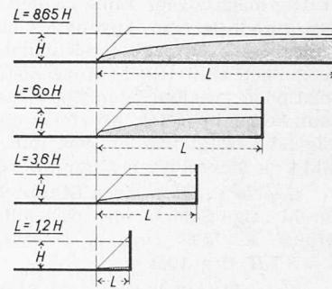
Im Durchschnitt wurden die Sickerlinien bei 6 verschiedenen  $k/(n_s \cdot v)$ -Werten untersucht über einen Bereich von etwa  $10^{-1}$  bis  $5 \cdot 10^2$ . Die Stauspiegeländerungen wurden als mit der Zeit linear verlaufend angenommen (siehe Bild 2).
