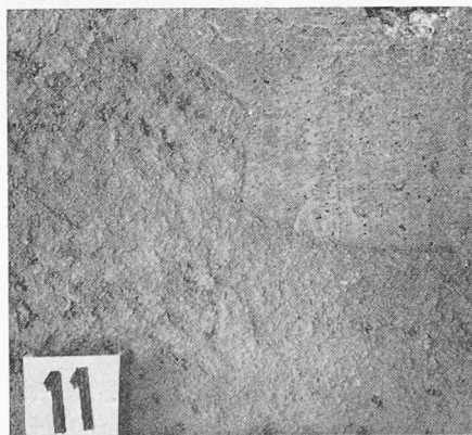
Nr. 11: Schalung mit ungehobeltem Holz, geölt. Haftung mässig bis gut
