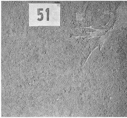
Nr. 51: Schalung ungehobeltes Holz, nicht geölt. Haftung des ZS sehr gut
