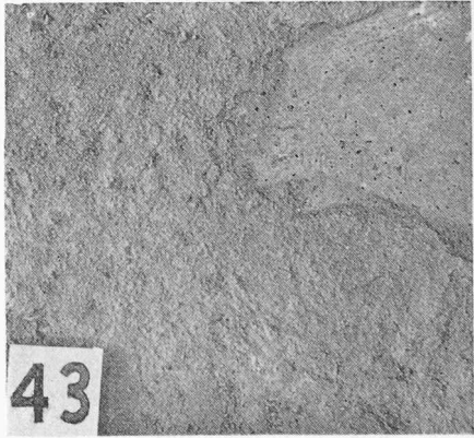
Nr. 43: Schalung aus Pavatexplatten, mit Paste behandelt. Nur mässige Haftung des ZS
